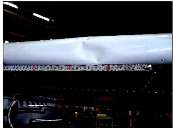
図2 損傷箇所（拡大）
