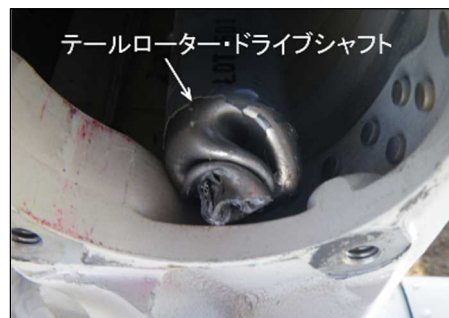
写真2 テールローター・ドライブシャフト破断部
