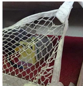
写真10 同社同型機のE L Tの取付/搭載状態
