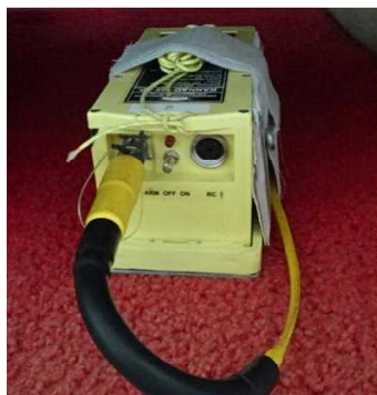
写真10 同社同型機のE L Tの取付/搭載状態
