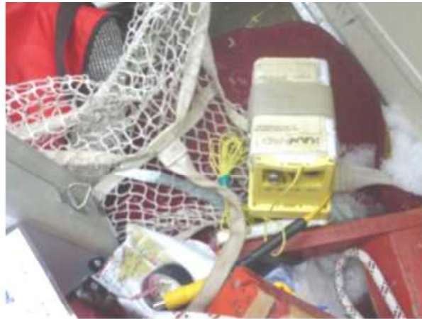
機体発見時、ELTは、後部座席の足元に転がっており 操作パネルのスイッチはオン(ON)位置であった。 ELTの補助アンテナは折損していた。
