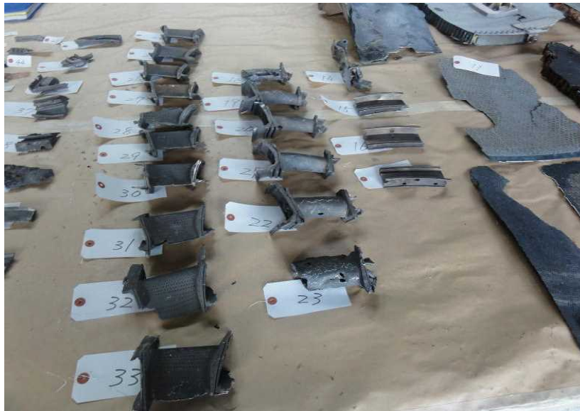
写真# 9 回収されたステーター・ベーン等
