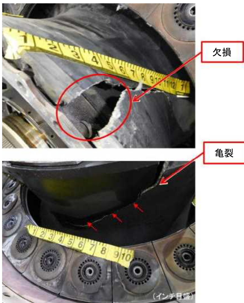
写真#5 内側のディフューザー・ケース
