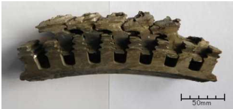
写真# 10 第1段HPTディスクのリム部の破片
