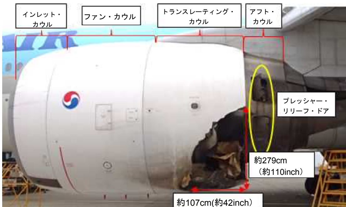
写真#14 トランスレーティング・カウルの損傷状況
