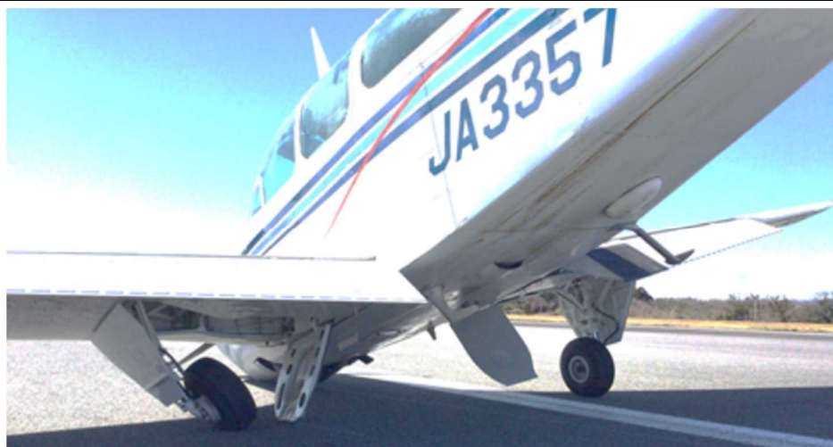
写真2 事故現場における脚の状況
