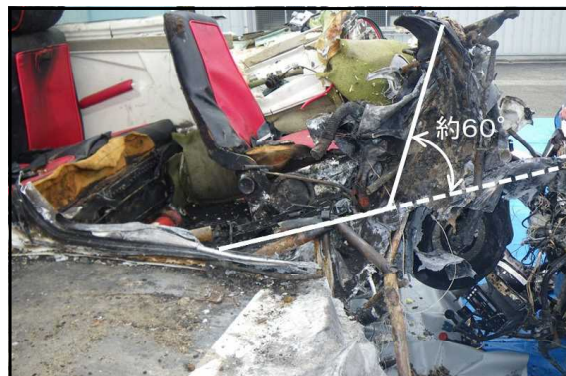
写真2 操縦席床面の屈曲状況
