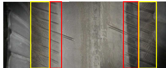
写真2.8.4-2 前脚用タイヤ内部 (赤枠が接触痕、黄枠がしわを示す)
