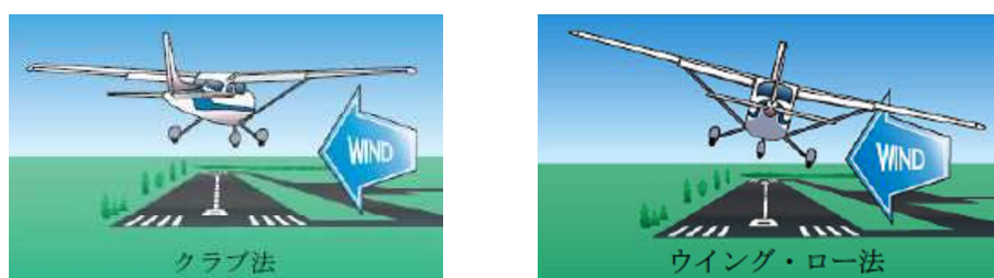
図2 クラブ法及びウイング・ロー法による進入
