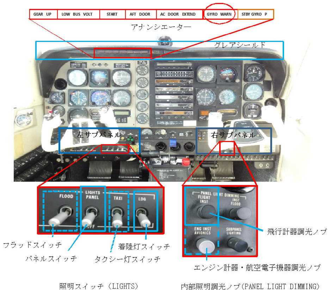
図2 同機の操縦室のスイッチ類の配置
