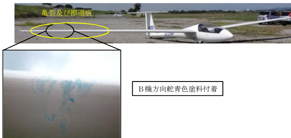
写真1 A機損壊状況
