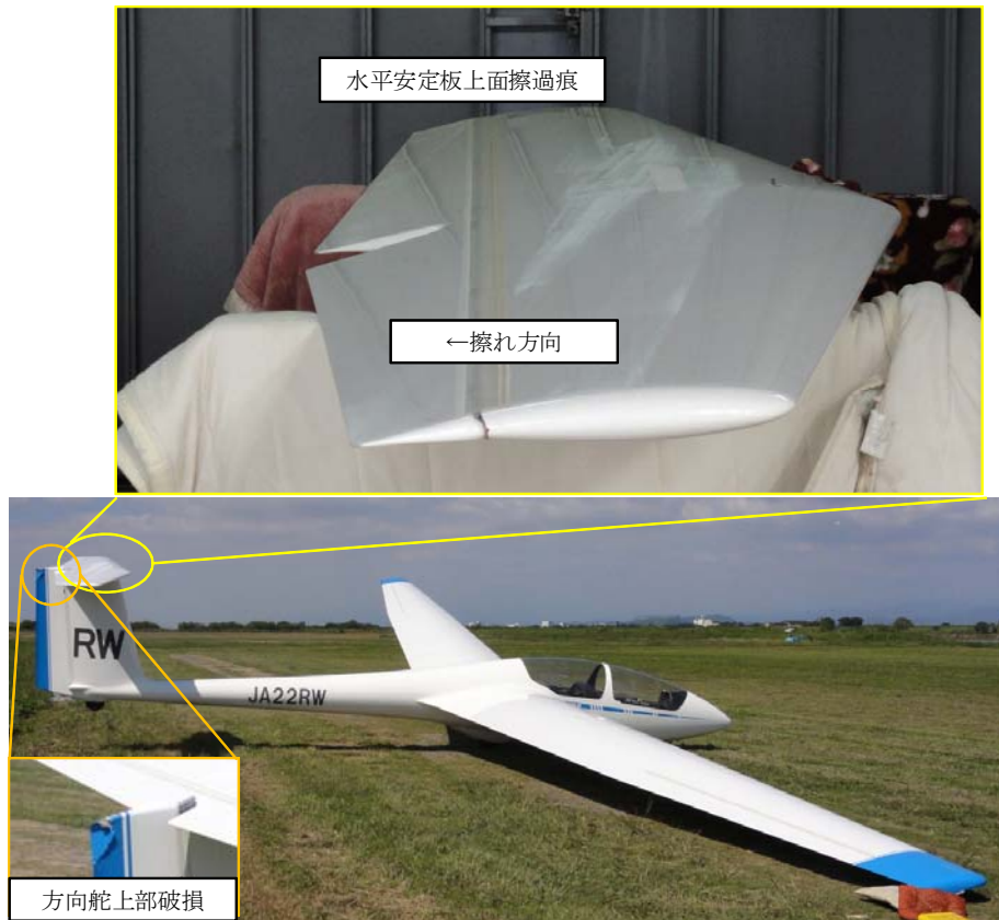
写真2 B機損壊状況
