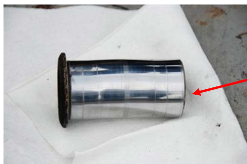
写真10 前方トラニオン・ボルト （ヒューズ・ピン）
