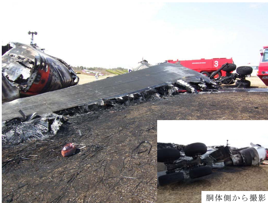
写真5 破断した左主翼
