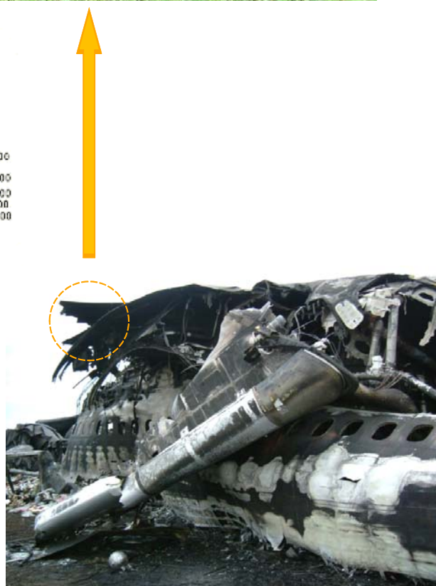
写真4 裏返しとなった事故機（左主翼破断部）
