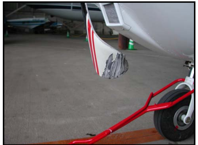
写真3 プロペラの損傷状況
