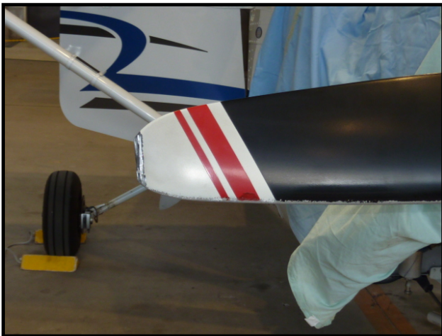
写真3 プロペラの損傷状況
