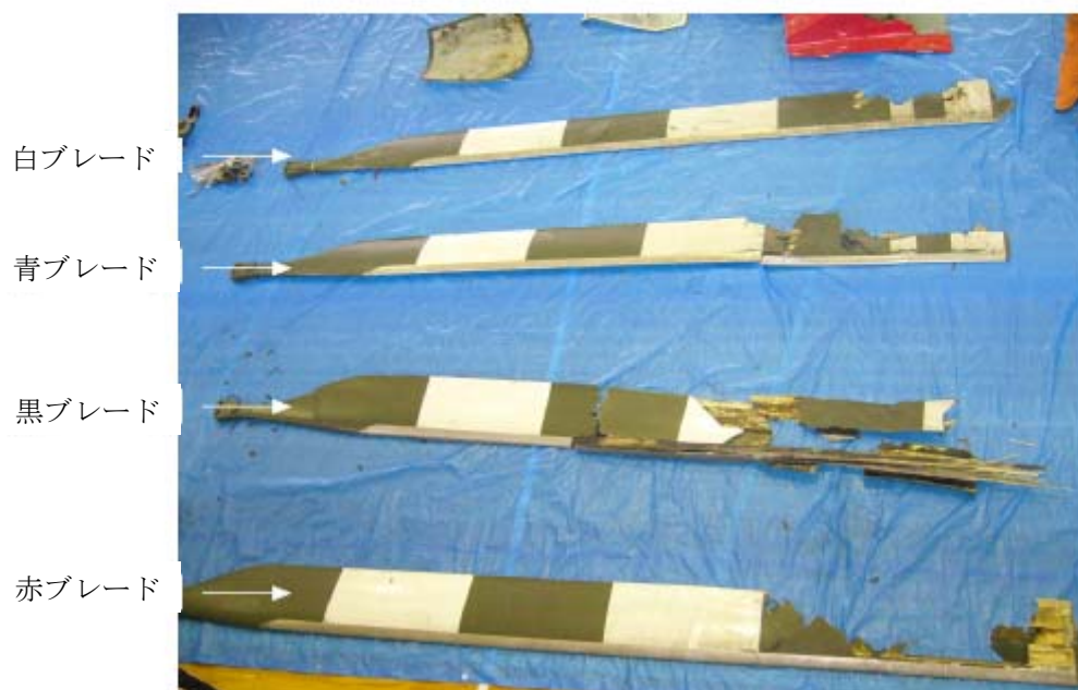
写真4 メイン・ローターの損壊状況
