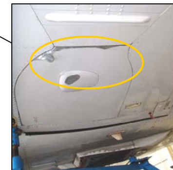
左主脚格納扉損傷
