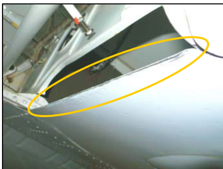
右主脚格納扉損傷
