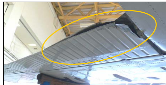
左翼フラップ損傷
