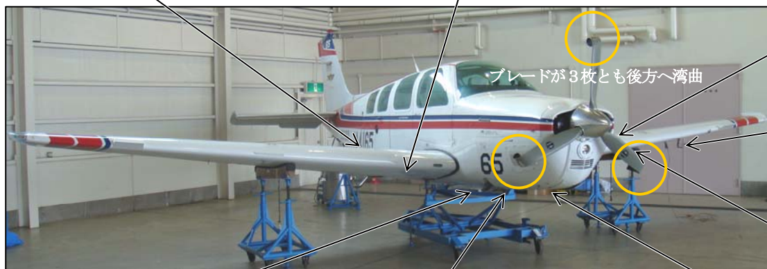
右主脚格納扉損傷
