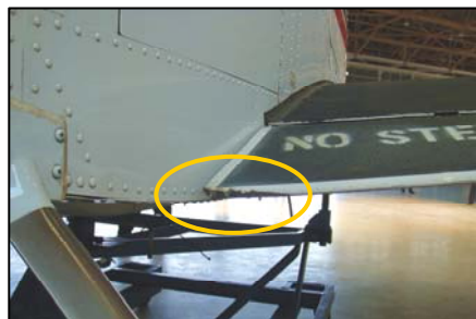
右翼フラップ損傷
