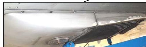
衝突防止灯及びエアコン コンデンサー損傷
