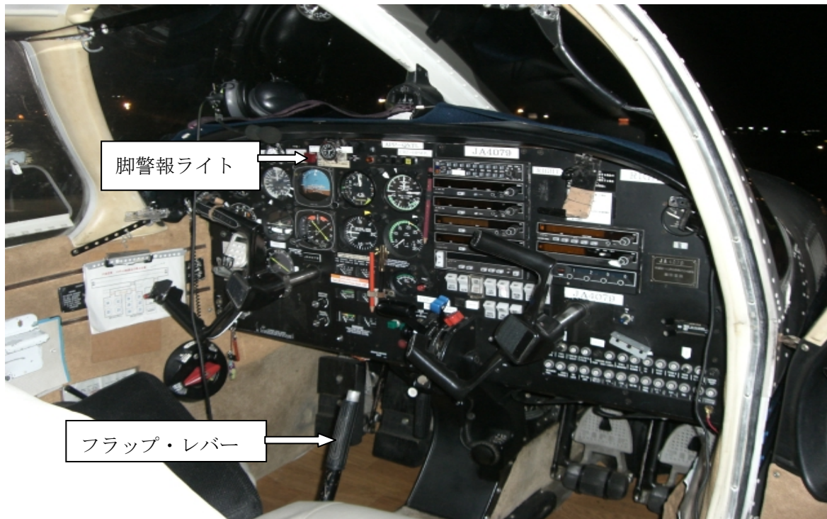
写真5 計器板の全景
