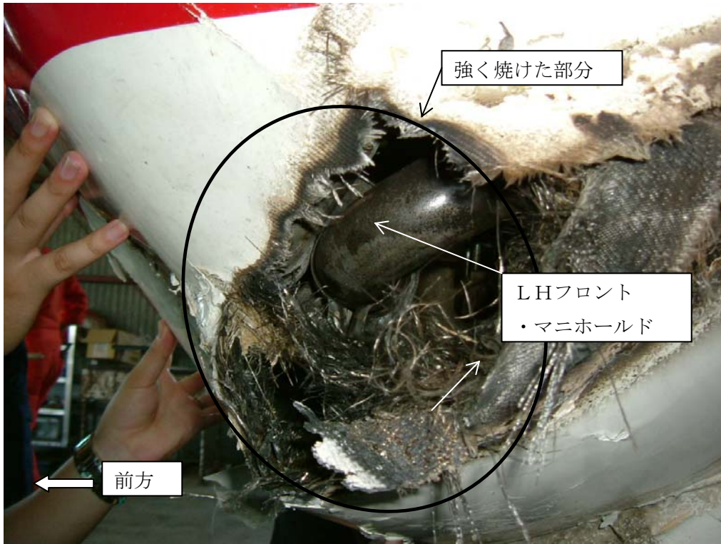
写真3 カウリングの焼けた部分（表側）
