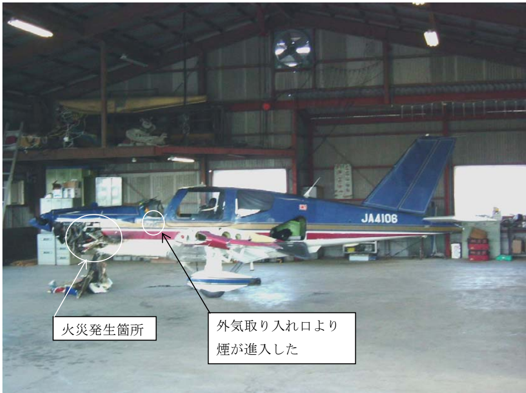
写真2 焼けたエンジン左側下部
