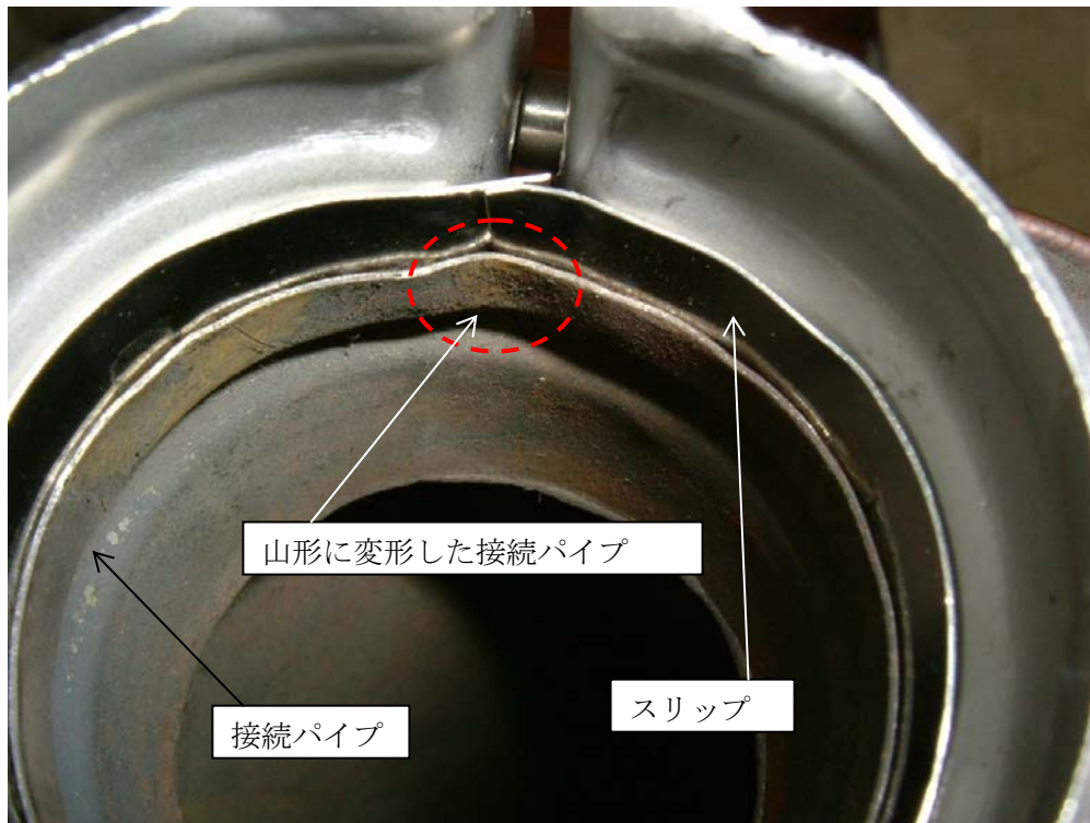
クランプを締め付け、接続パイプが変形し始めた状態
