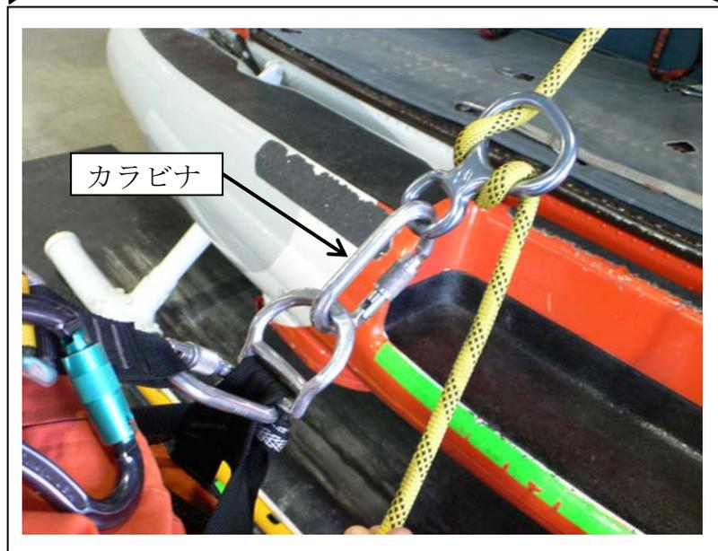
写真4 ロープのよれが発生した箇所
