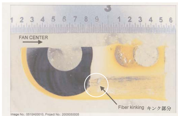
写真D スプールの軸に直角な面の断面
