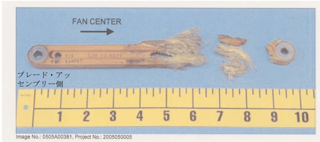
写真A 破断したTTストラップ
