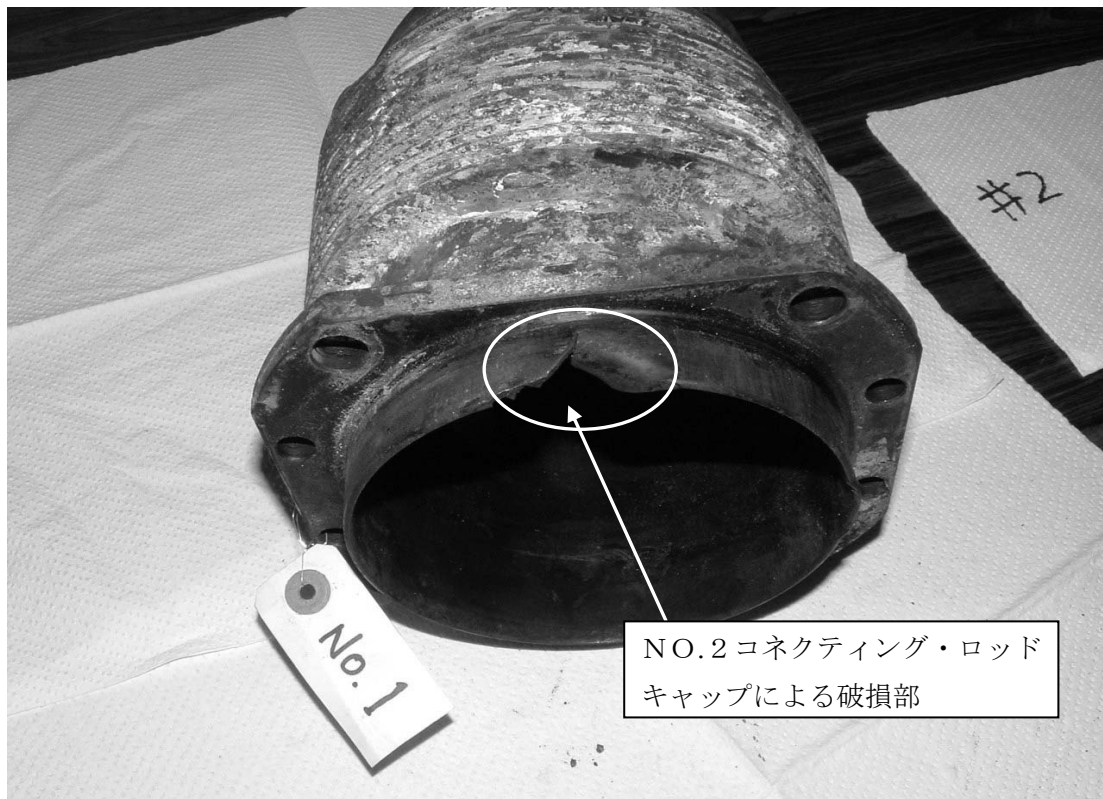
写真10 NO.1シリンダー・スカートへの破損状況
