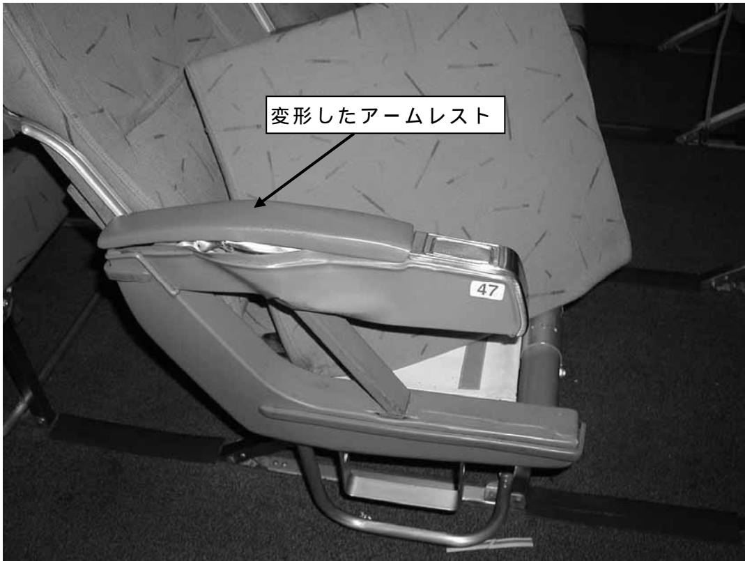
写真1 損傷した座席
