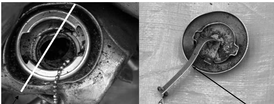
写真4 左エンジンのオイルタンク給油口及びキャップ
