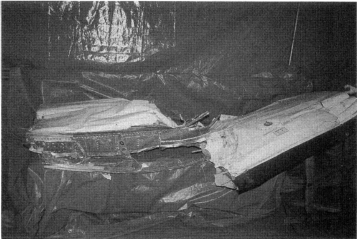
写真 10 左主翼破損状況
