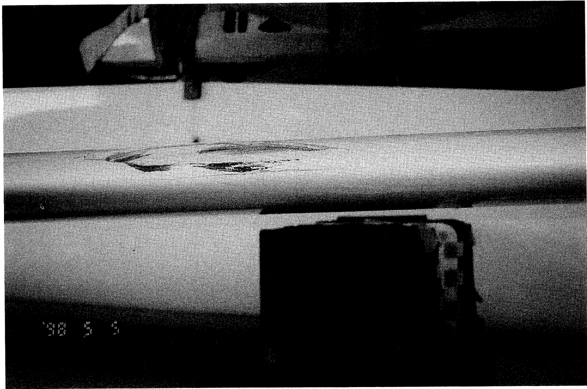
写真 1 A機左主翼前縁損傷状況
