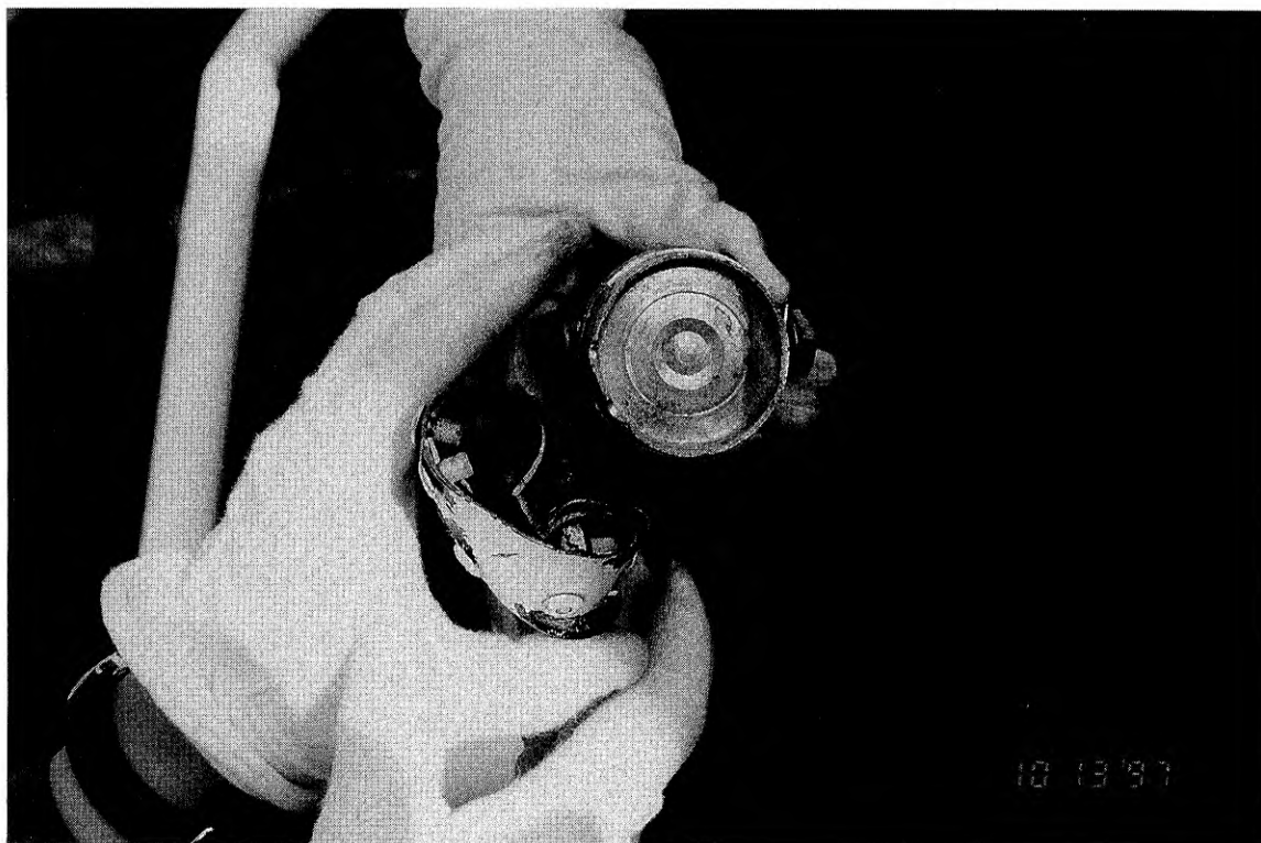
写真5 左翼ストラットの破断部
