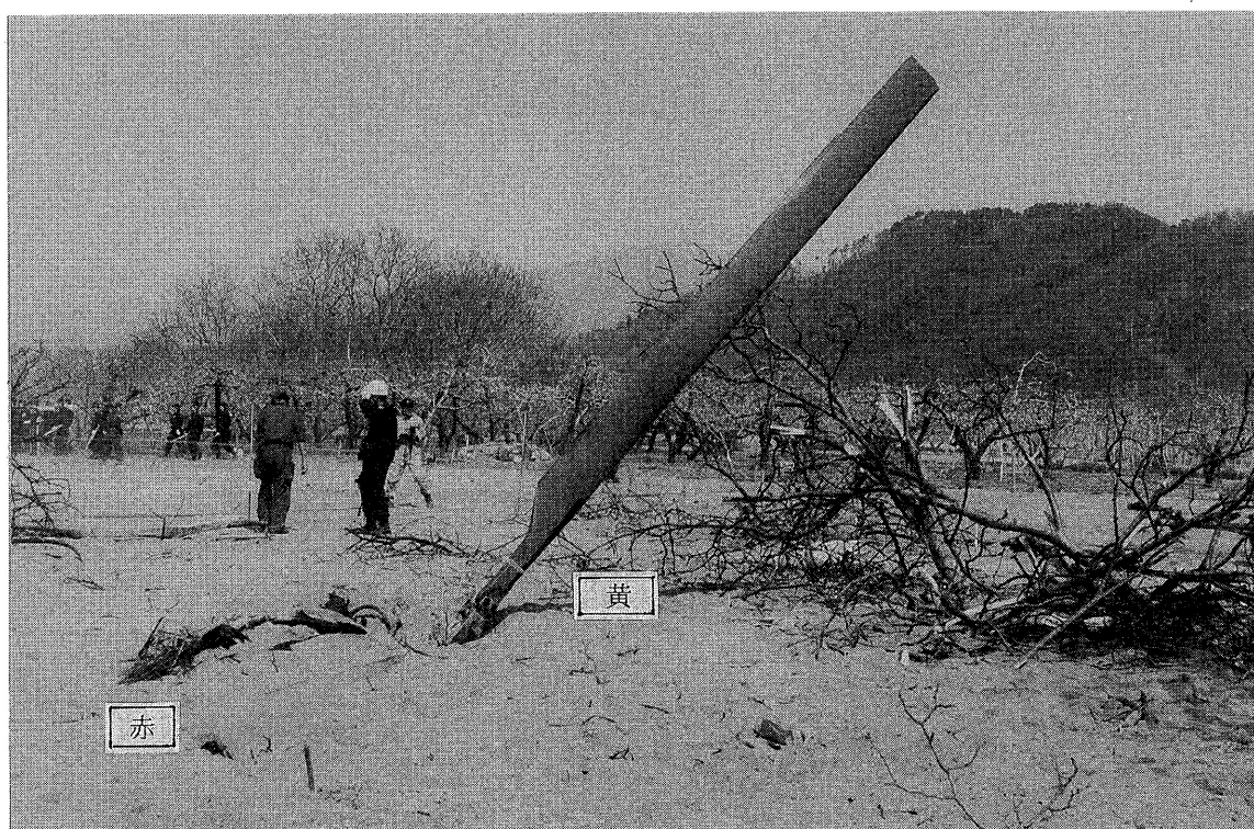
写真2-2 地中に埋没したメイン・トランスミッション及び メイン・ロータ・ブレード (A機)
