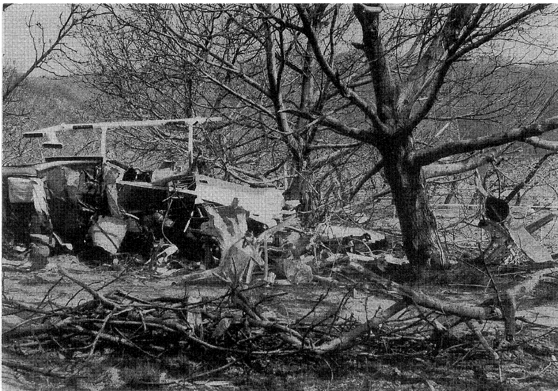
写真4-2 地中に埋没したメイン・トランスミッション (B機)
