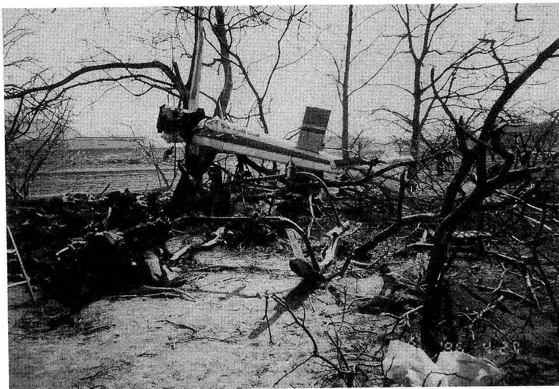
写真2-2 地中に埋没したメイン・トランスミッション及び メイン・ロータ・ブレード (A機)
