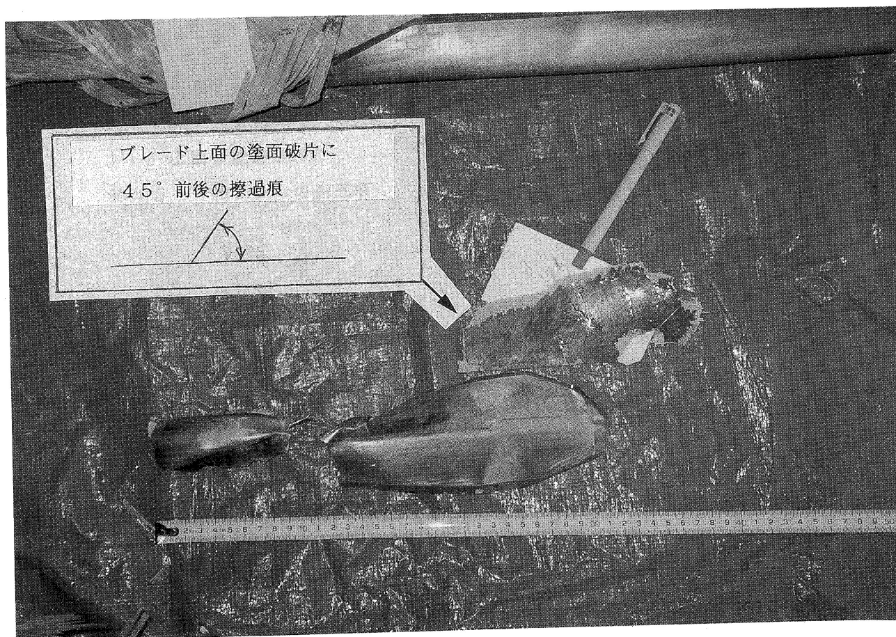
写真5-5 接触推定位置の前縁金属カバー及び塗面破片 (B機) (赤メイン・ロータ・ブレード)
