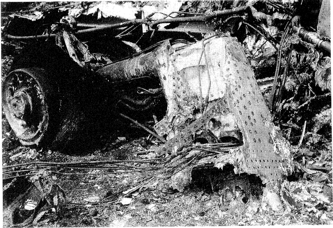
写真7 右主脚及びアタッチ・フィッティング
