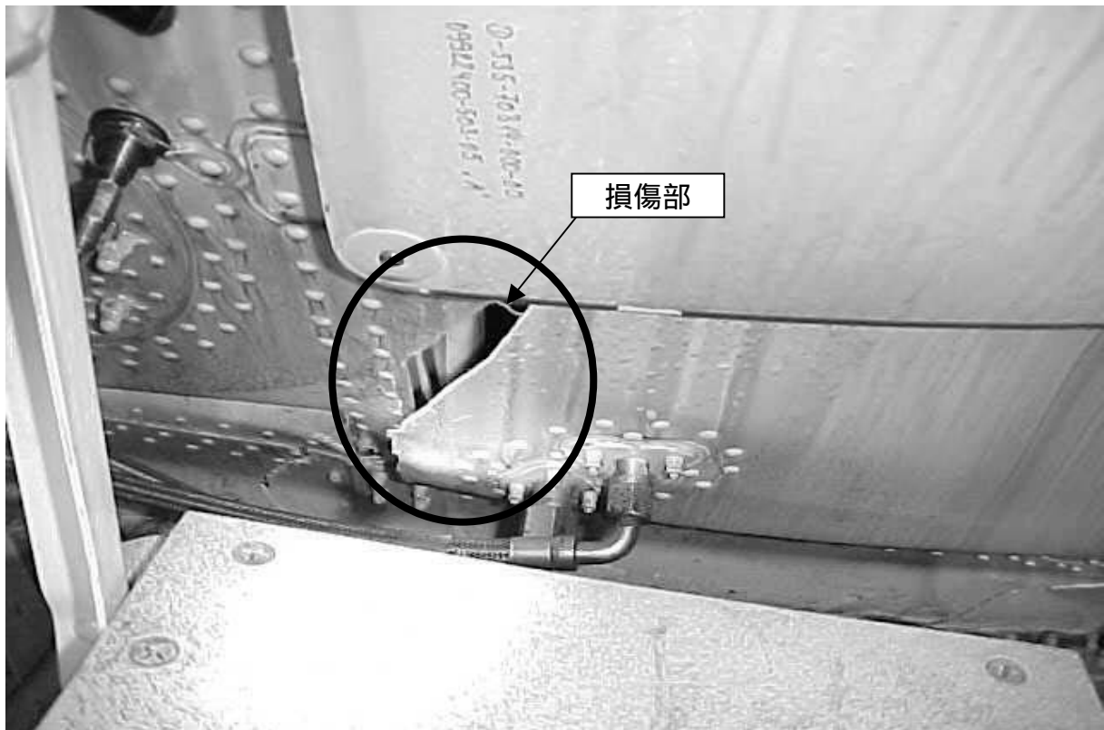
写真5 圧力隔壁の損傷
