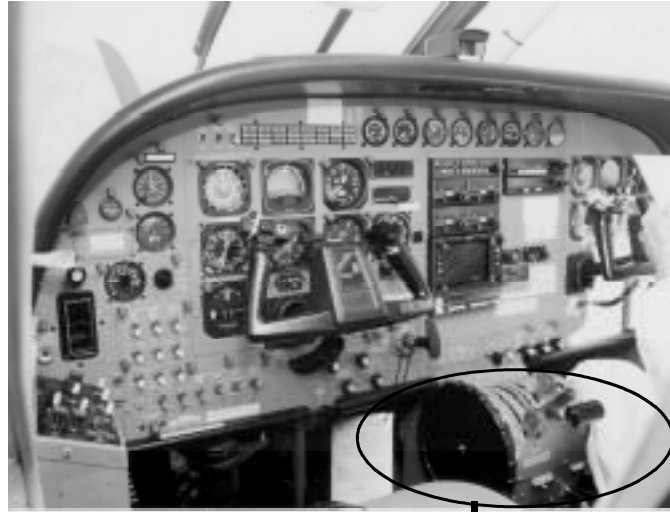
写真4 コントロール・コードラント
