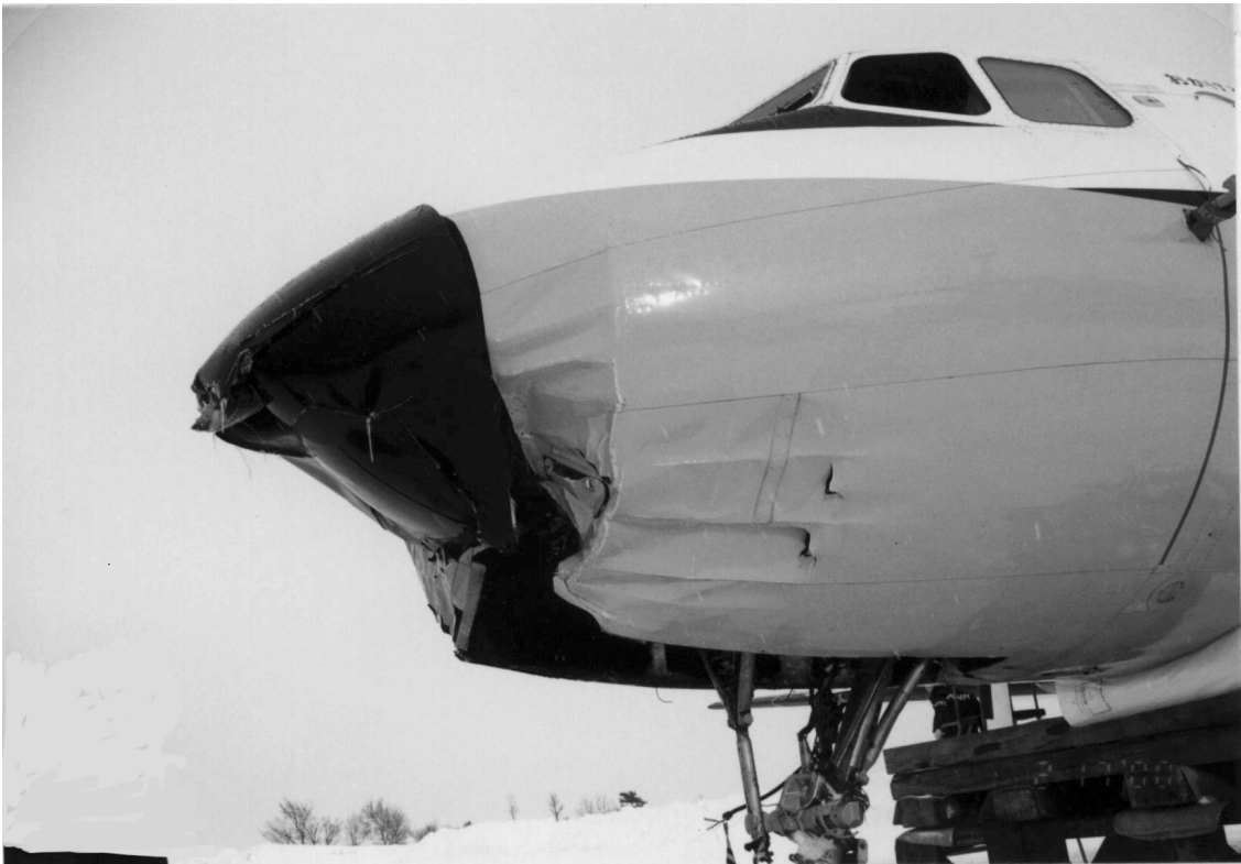
写真2 前部胴体の破損状況
