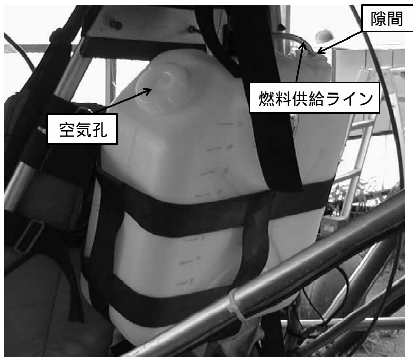
事故前に使用していたタンク
