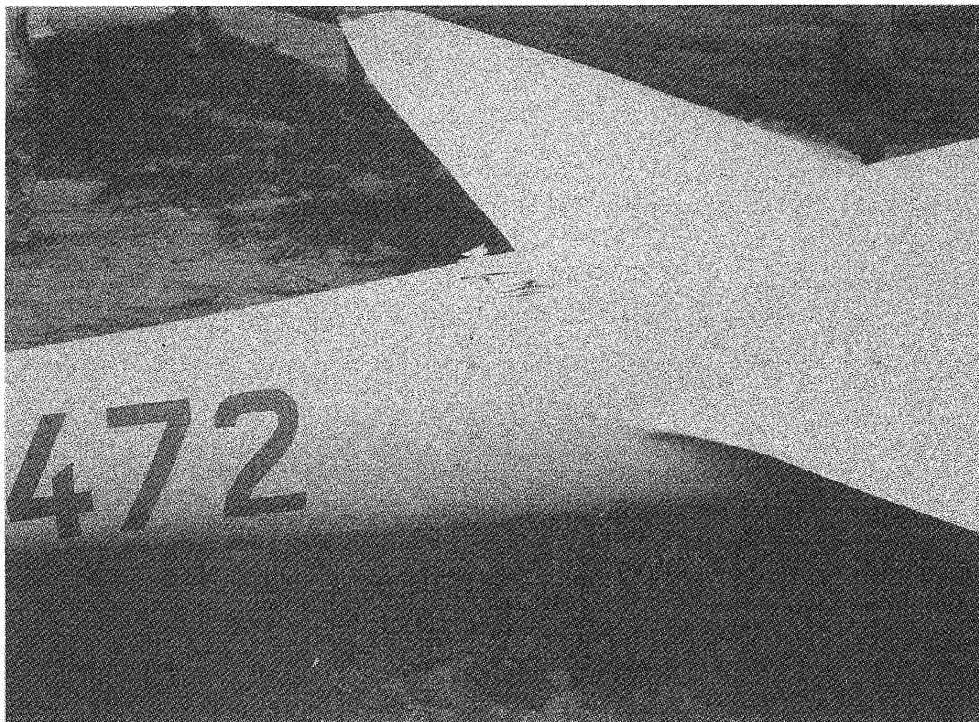
写真 1 胴体中央部右側損傷状況
