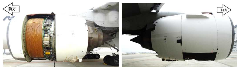
図9 ファンカウルの損傷状況
