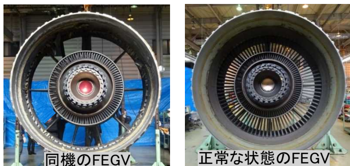
図7 FEGVの損傷状態
