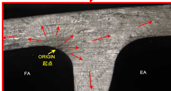
図14 疲労破壊の起点領域
