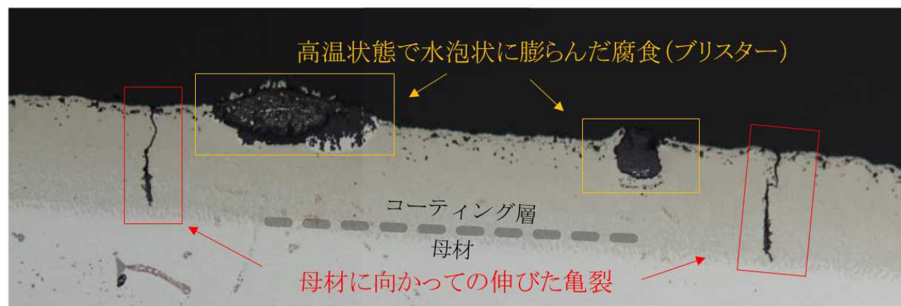
報告書 図7 13番ブレードの破断起点付近のコーティング層(断面) (コーティング層の亀裂及び腐食の状況) (抜粋)
