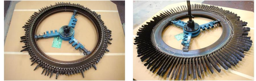
図4 LPT第5段(左側)及び第6段(右側)動翼の損傷状況
