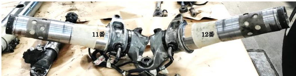
図5 折損した右主脚後方の車軸（後方から）
