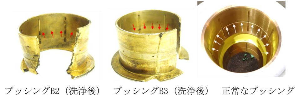
図15 ブッシング内径面のグリースの通路 (溝)
