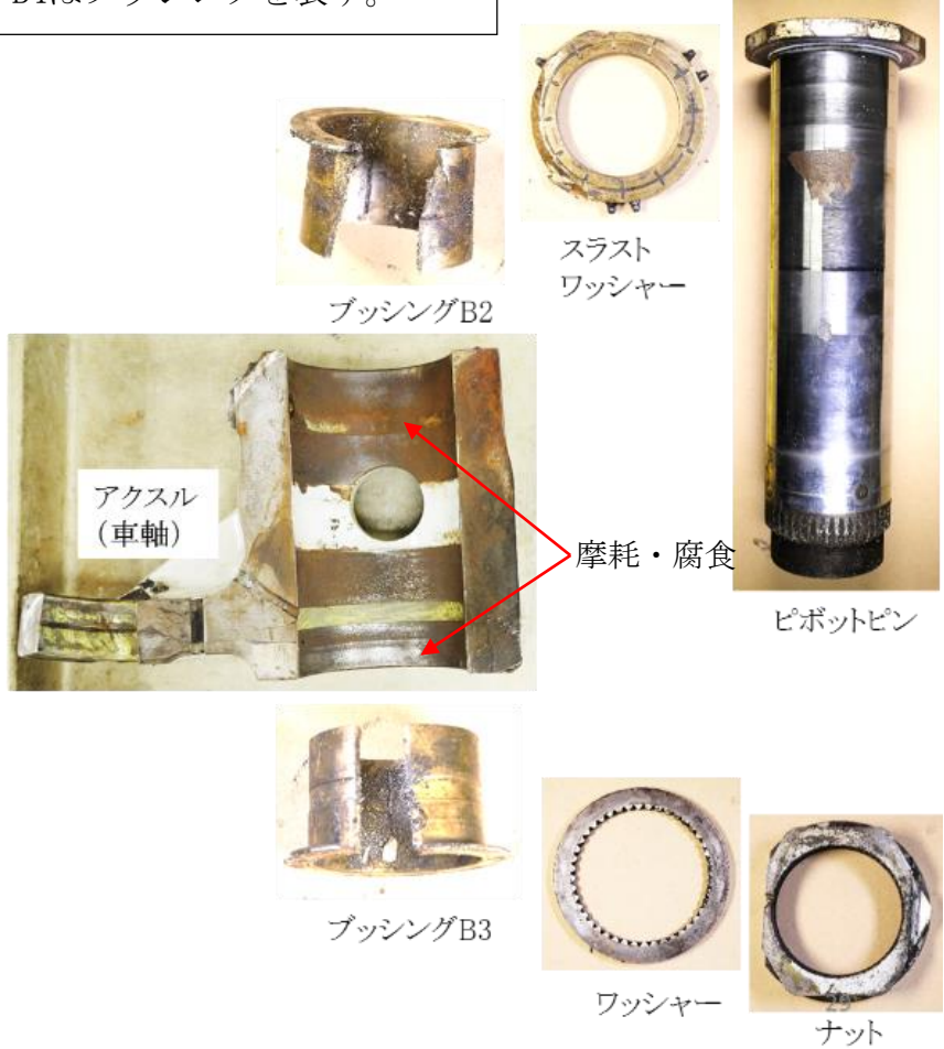
図 1 3 ピボット部の断面図と分解した部品
