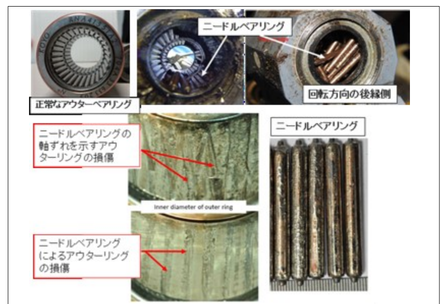
損傷したアウトターベアリング
