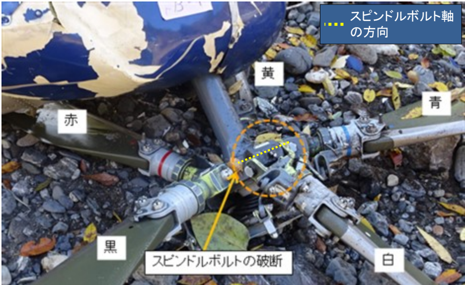
白色ブレードのスピンドルボルトの破断
