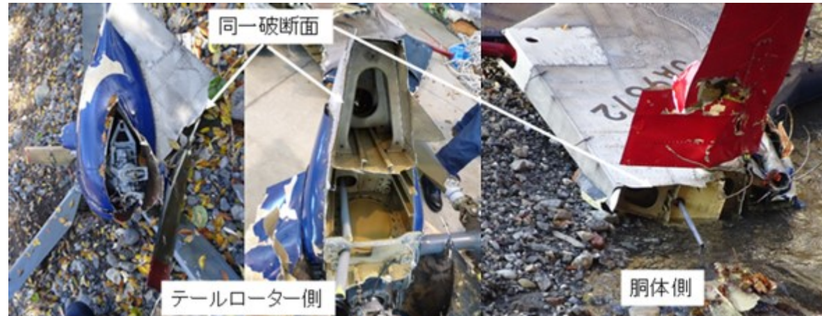
機体から分離したテールローター下部の破断面
