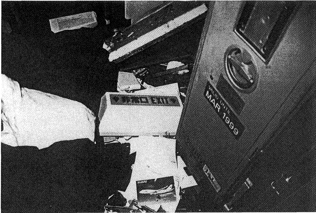
写真3 飛散した非常口カバー (L4ドア)
