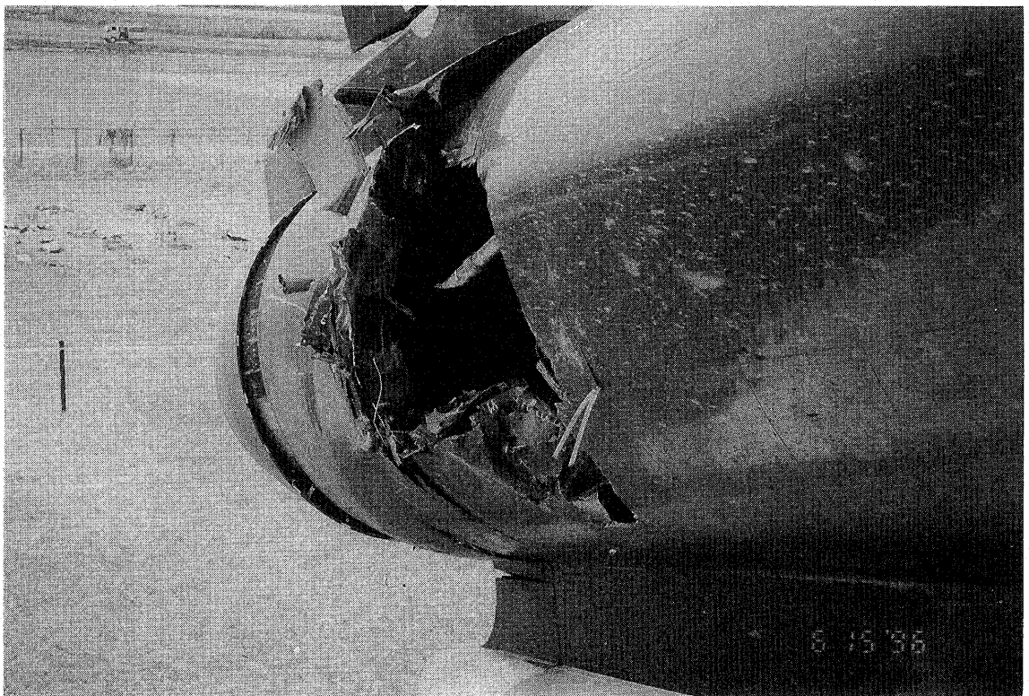
写真3-2 No. 2エンジン (エア・インレット・ダクト破孔部)
