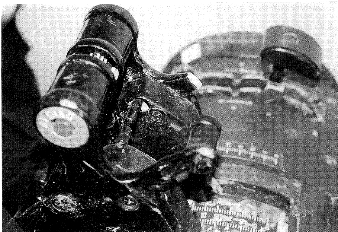
写真37 スラスト・レバー及びゴー・レバー
