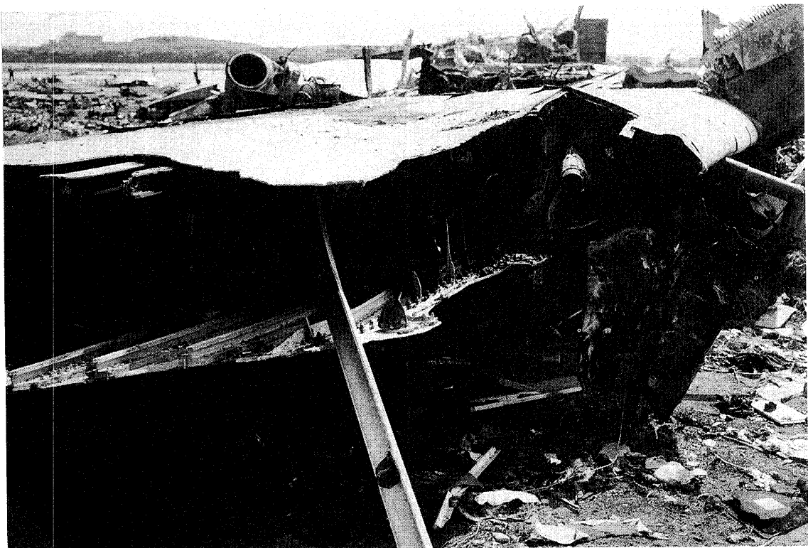
写真20 右主翼の破断箇所
