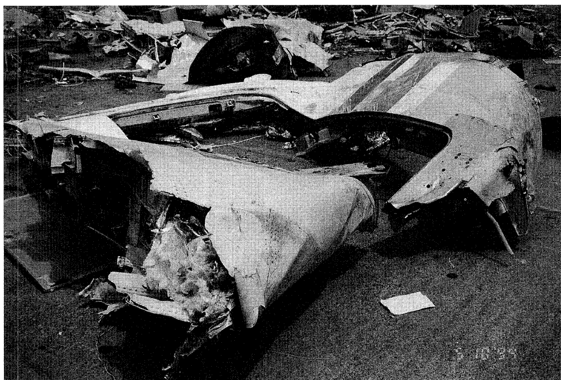
写真28 R1 ドア周辺外板
