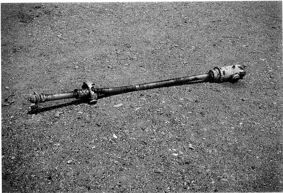
写真14 左フラップ No. 3スクリュウ・ジャッキ
