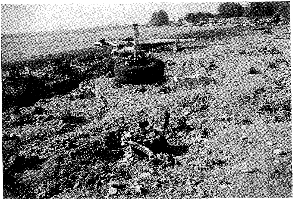
写真22 左主脚タイヤ及びブレーキ・アセンブリ
