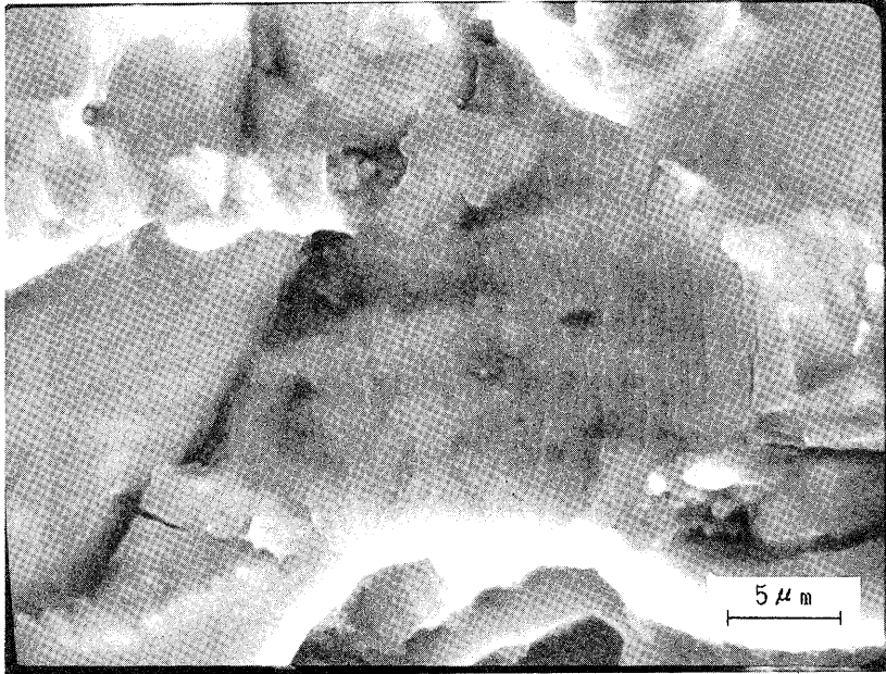
写真-110 リベット孔34番内舷(孔縁より3.05mm位置)
