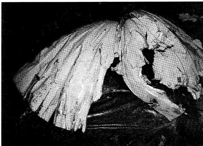
写真- 71 後部圧力隔壁パート3(非与圧側)
