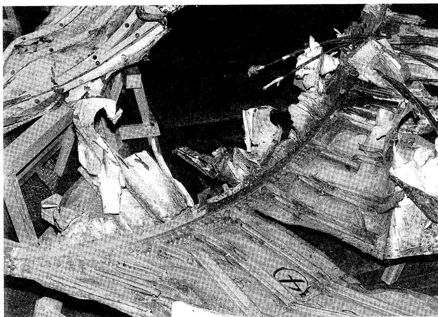
写真- 72 後部圧力隔壁パート4(与圧側)
